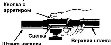
3. Крепко удерживая двигатель и верхнюю секцию штанги, вытащите насадку из сцепки.
