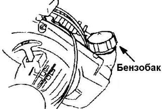
2. Снимите крышку бензобака, повернув её против часовой стрелки. Наполните бензобак до основания горловины.
