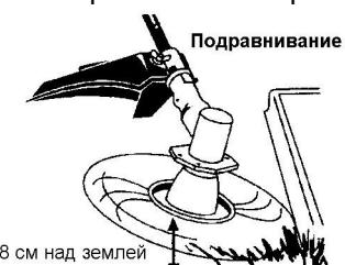
**ПОЛНОЕ СРЕЗАНИЕ** – Данный метод позволяет полностью удалить сорняки. В данном случае следует удерживать головку с леской на высоте 8 см над землей и под углом. При обработки поверхности около деревьев, столбов и т.д. леска должна ударяться о землю. Использование этого метода ведет к увеличению износа лески.
