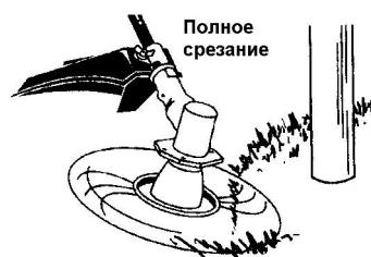
**КОШЕНИЕ** – С помощью бензокосы можно обрабатывать труднодоступные участки газона, которые не под силу газонокосилке. При кошении удерживайте головку с леской параллельно поверхности земли. Не прижимайте головку к земле, так как это может повредить её.
