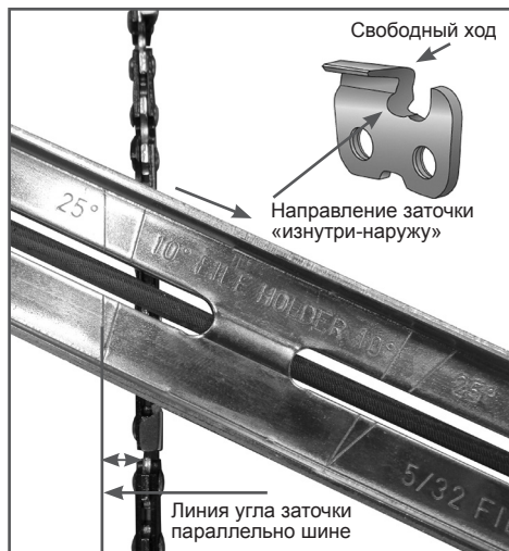
Рис. 22 Расположение линии угла заточки
