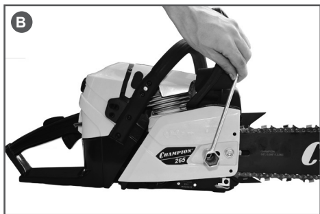
Рис. 5 Затяжка гайки крепления шины
