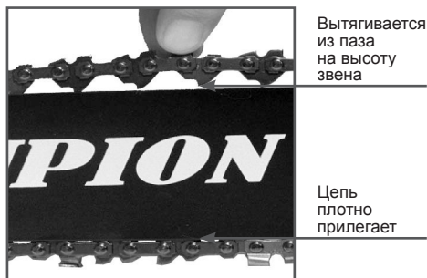
Рис. 6 Регулировка натяжения цепи
