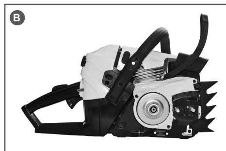
Рис. 3 Снятие крышки шины
