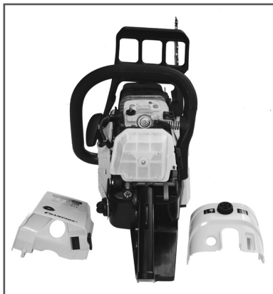
Рис. 28 Снятие крышки цилиндра
