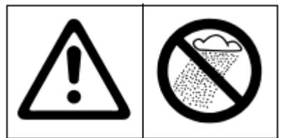
**Опасность повреждения оборудования:** не используйте воду под давлением для чистки оборудования; не производите работы по обслуживанию под дождем.
