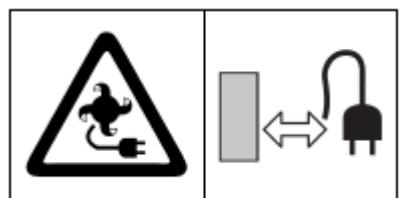
**Предупреждение!** Не допускайте соприкосновения силового кабеля с рабочими спицами тяпки.
